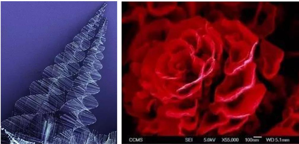
图4 左图这两棵小树是硫化物纳米线形成的复杂结构，它的“树干”其实是大量的螺位错，看起来呈螺旋形态，右图通过分子束外延加工形成的晶态纤锌矿氮化镉纳米“花”。
