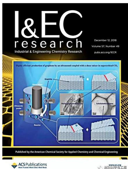
图 1：超临界二氧化碳中，超声波与剪切搅拌协同剥离石墨制备石墨烯的原理示意图
